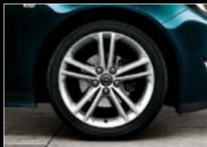
Jante din aliaj, 8 J x 18", design cu 5 spițe duble, pneuri 245/45 R 18 (RV1). 7
