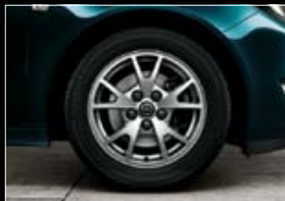
Jante din aliaj, 6,5 J x 16", design cu 5 spițe în V, pneuri 215/60 R 16 (RRZ). 3
