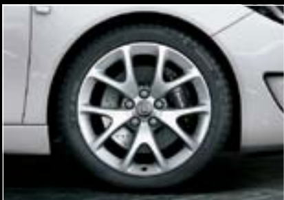
Jante OPC din aliaj, 8.5J x 19", design cu 5 spițe duble, pneuri 245/40 R 19 (REH).
