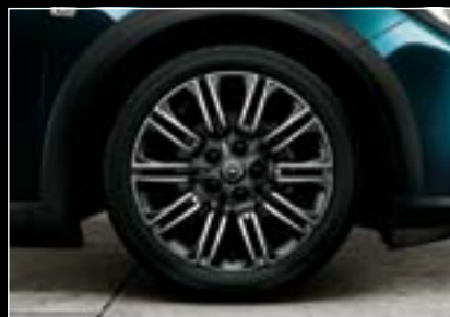
Jante din aliaj, 8 J x 18", design cu 10 spițe duble, finisaj bicolor, pneuri 235/50 R 18 (REP). 2
