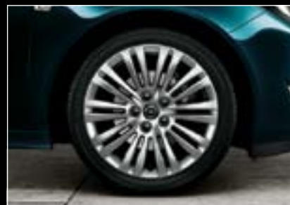
Jante din aliaj, 8 J x 18", design cu 10 spițe duble, pneuri 245/45 R 18 (RT4). 9
