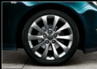
Jante din aliaj, 8 J x 18", design cu 10 spițe, pneuri 245/45 R 18 (RED). 3
